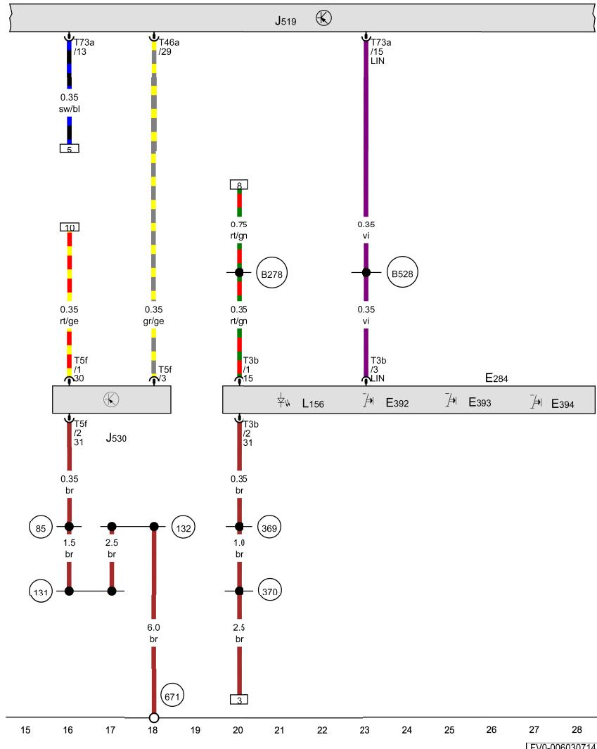
车库门开启操作单元, 车库门遥控器按钮 1, 车库门开启装置控制单元
